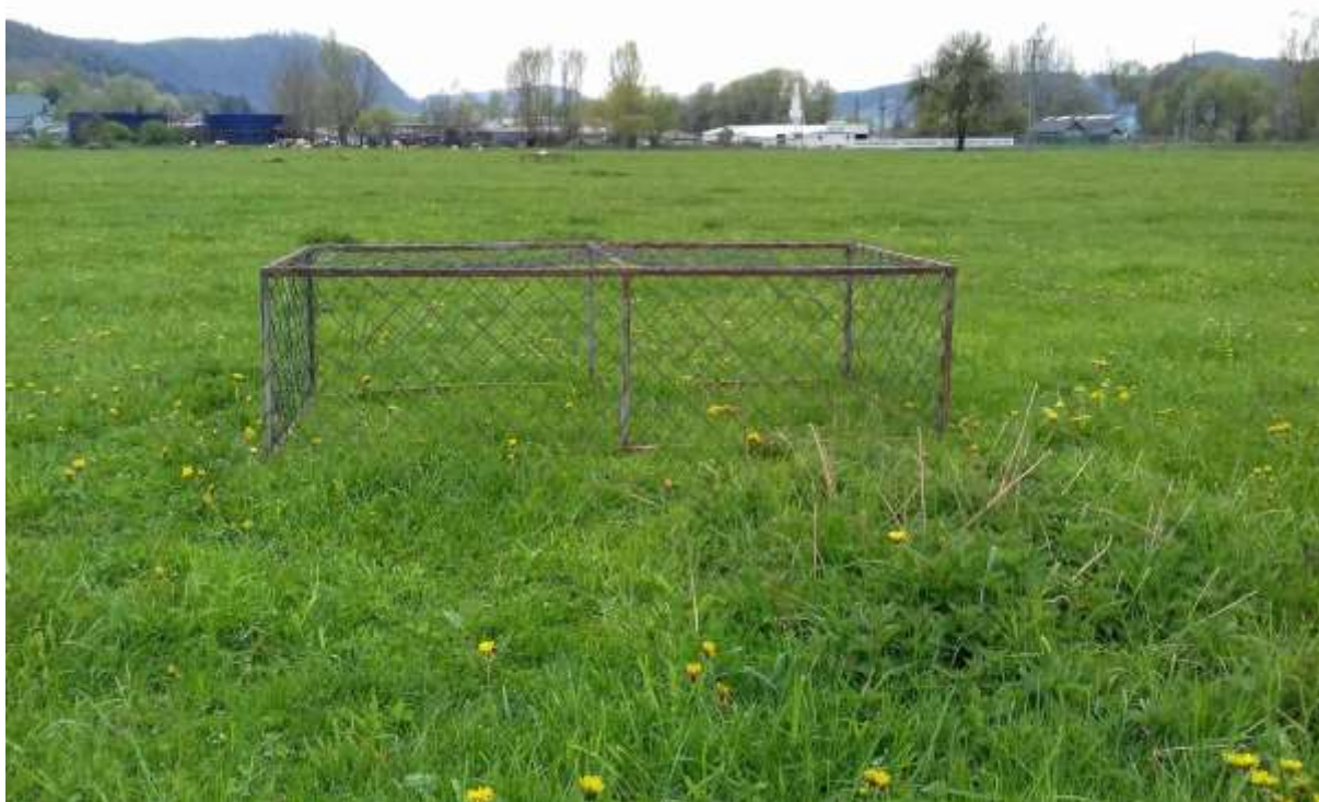
Obrázok 3 Kovová kletka na zisťovanie množstva produkcie fytomasy
