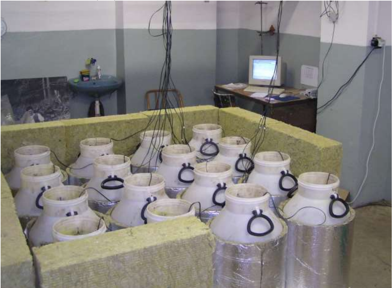
Obr. 1 Pokusné nádoby naplnené biomasou s čidlami na meranie parametrov.
