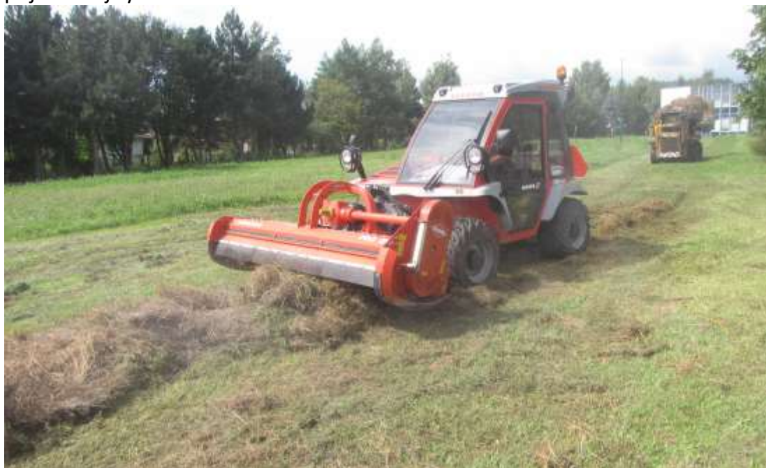
Obr. 4 Prejazd horského traktora VITHAR s mulčovacím prípojným zariadením pri najnižšej pojazdovej rýchlosti
